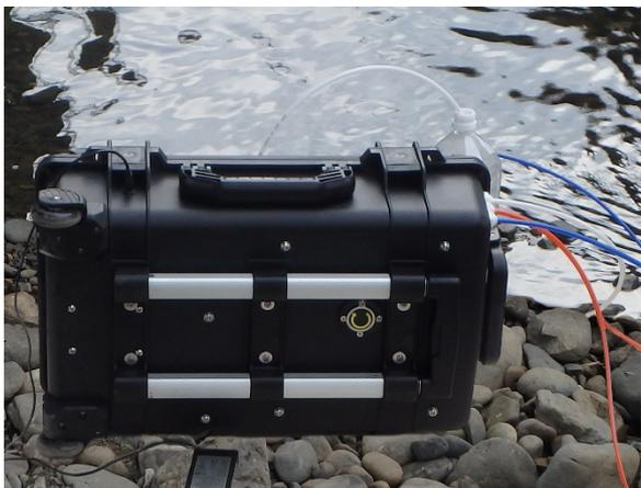
EMERGENCY-Hの機能に加えて電動ポンプを装備。電気が使用できる場所では電動で楽に浄水ができます。
